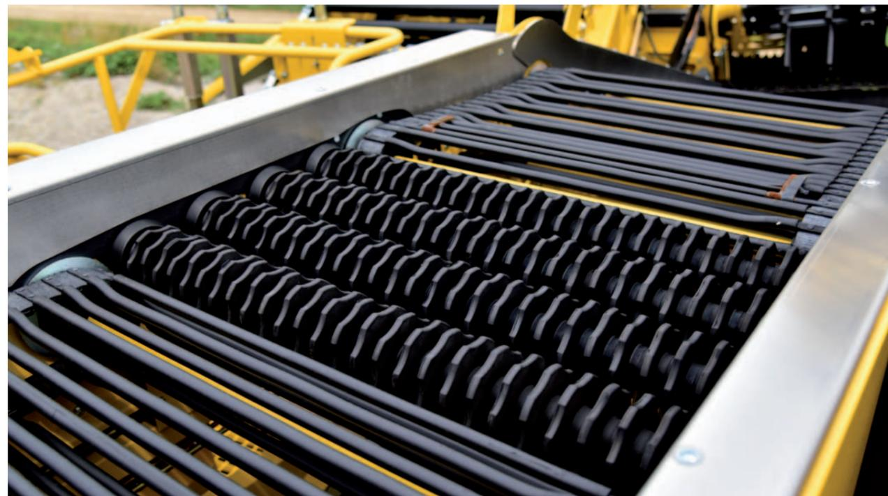
Sortierwalzen, stufenlos verstellbar von 25 bis 40 mm
