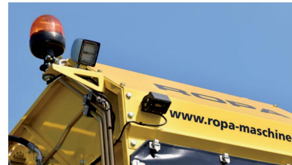
Rückfahrkamera am Heck, Rundumleuchte
