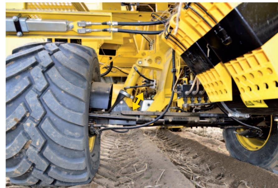
Automatischer hydraulischer Neigungsausgleich
