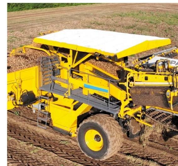
Sonnenschutzdach, höhenverstellbar (optional, erweiterbar um Seitenverkleidung)
