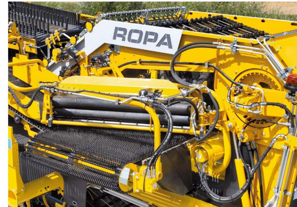
Eine weitere Axialkolbenpumpe versorgt die Antriebe für UFK (Umlaufender Fingerkamm), sowie die Ableitwalzen von Igel 1. Ein entscheidender Vorteil, denn im Ergebnis ergibt dies einen Leistungsgewinn durch eine noch bessere Abtrennung und deutlich mehr Antriebsleistung am Igel 1. Zudem kann die Geschwindigkeit der Ableitwalzen am Igel 1 separat zur Geschwindigkeit des Igel 1 verstellt werden.
