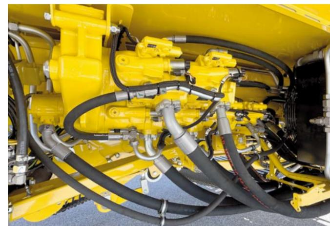
Funktionen sowie gesteigerte Antriebsleistung. Als Alleinstellungsmerkmal wohl unter allen Traktor gezogenen Anbaugeräten verfügt der Keiler 2 über einen vollhydraulischen Antrieb aller Trennsysteme, Bänder und Ketten in Verbindung mit einer internen, elektronisch geregelten Load-Sensing Arbeitshydraulik. Diese langlebige Konstruktion ist präzise ansteuerbar und ermöglicht eine gesteigerte Erntequalität bei gleichzeitiger Kraftstoff- und Ressourcenschonung.
