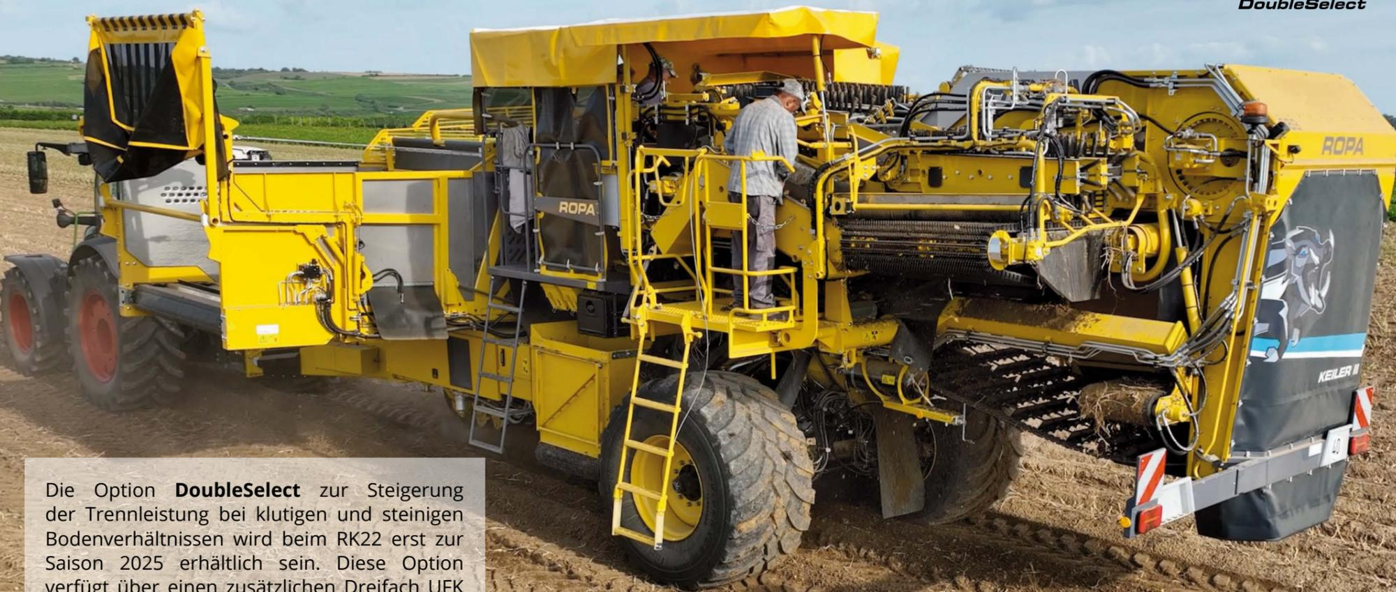
Die Option **DoubleSelect** zur Steigerung der Trennleistung bei klutigen und steinigen Bodenverhältnissen wird beim RK22 erst zur Saison 2025 erhältlich sein. Diese Option verfügt über einen zusätzlichen Dreifach UFK am Igel 2 mit einer separaten Beimengenspur und zusätzlich einschiebbarem Verlesestand neben dem Igelband 3. Der zusätzliche UFK wird beim RK22 Double-Select mit elektrischen Hubspindelmotoren beidseitig in der Höhe präzise einstellbar sein.
