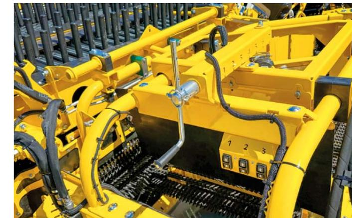
Horizontale Verschiebung der Ableitwalzen am Igel 3
