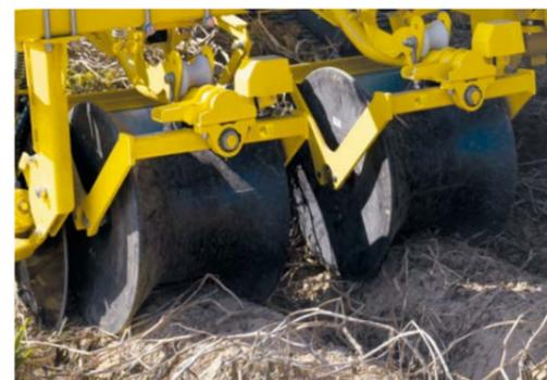
Dammtrommeln aus Kunststoff, hydraulisch angetriebenes Scheibensech aussen
