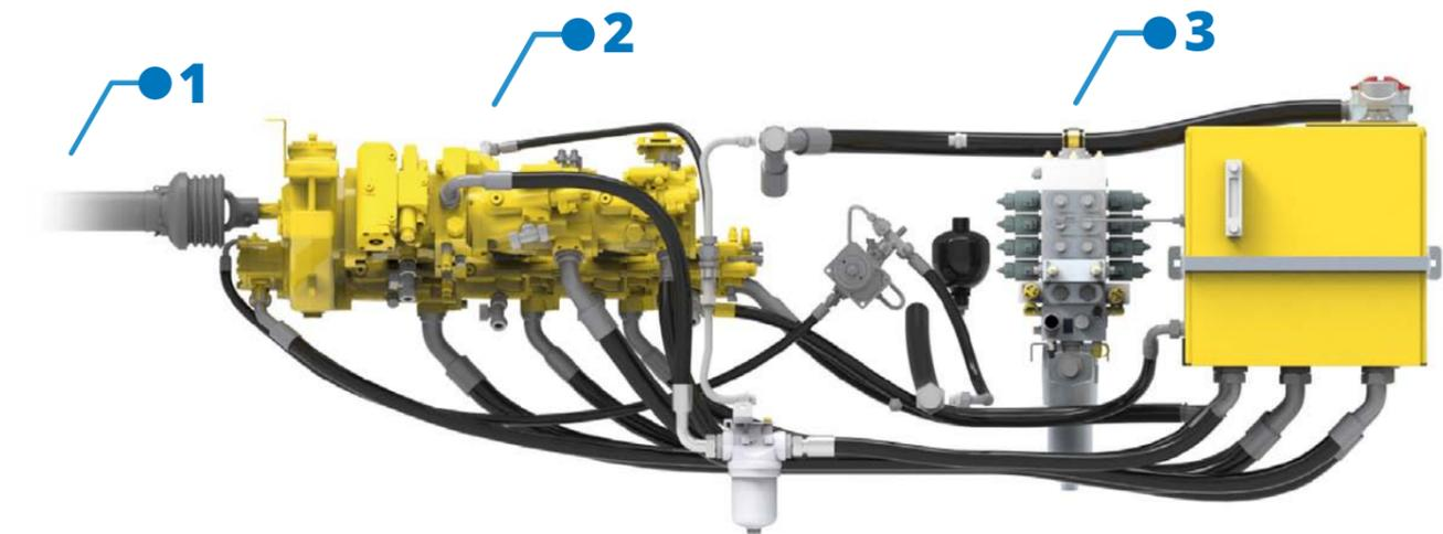
Im Vergleich zum Vorgängermodell wurde der vollhydraulische Antrieb mit zwei zusätzlichen Axialkolbenverstellpumpen ausgerüstet. Dabei wird eine Zahnradpumpe durch eine Axialkolbenpumpe für die Antriebe in der Aufnahme ersetzt. Dies betrifft den Scheibensechantrieb bzw. Deckband und Rodewelle bei der Schwadaufnahme.
