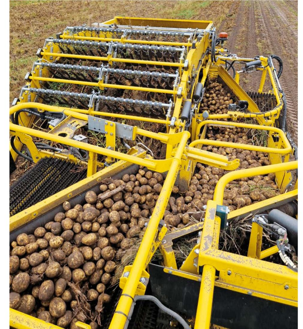
Keiler 2 4-Igel ohne umlaufenden Fingerkamm
