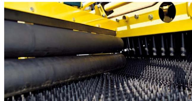
Übergang Igel 3 in umlaufenden Fingerkamm
