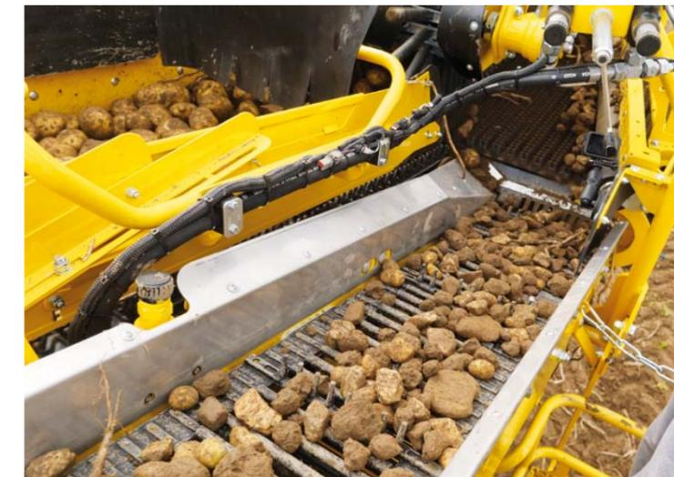
Durch eine frühe erste Abtrennung von Kluten und Steinen im Gutstrom werden Beschädigungen an den Kartoffeln im weiteren Verlauf deutlich reduziert und somit die Kartoffeln noch schonender geerntet. Jede UFK-Einheit kann alternativ auch mit umlaufenden Bürsten (UBK) bestückt werden.
