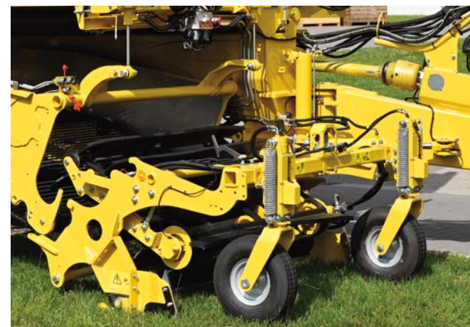
Dammaufnahme mit beidseitig gezackten Hohlscheiben
