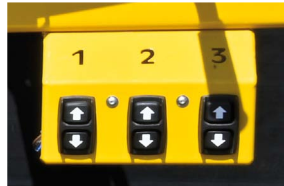
Höhenverstellung der Ableitwalzen mittels Linak Linearantriebe
