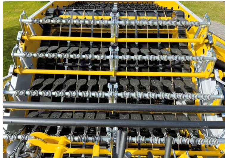
Verbesserter Krautkettenverlauf und Krautrückhaltefedern
