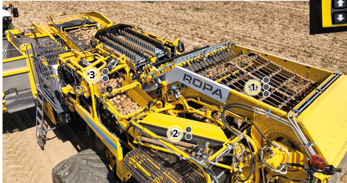
Höhe und Neigung der Trennaggregate sind bequem per Knopfdruck stufenlos hydraulisch und elektronisch anpassbar
