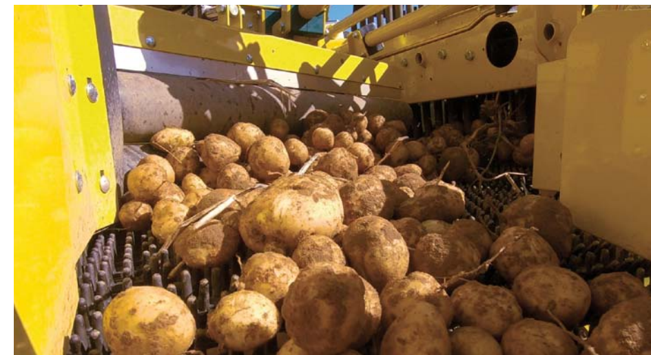
Übergang Igel 3 auf 4
