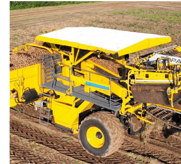
Sonnenschutzdach, höhenverstellbar (optional, erweiterbar um Seitenverkleidung)
