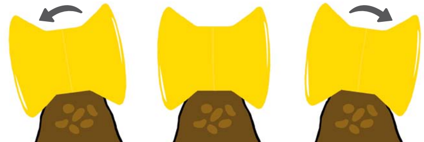
Lenkungssignal wird über den Kippwinkel abgenommen
