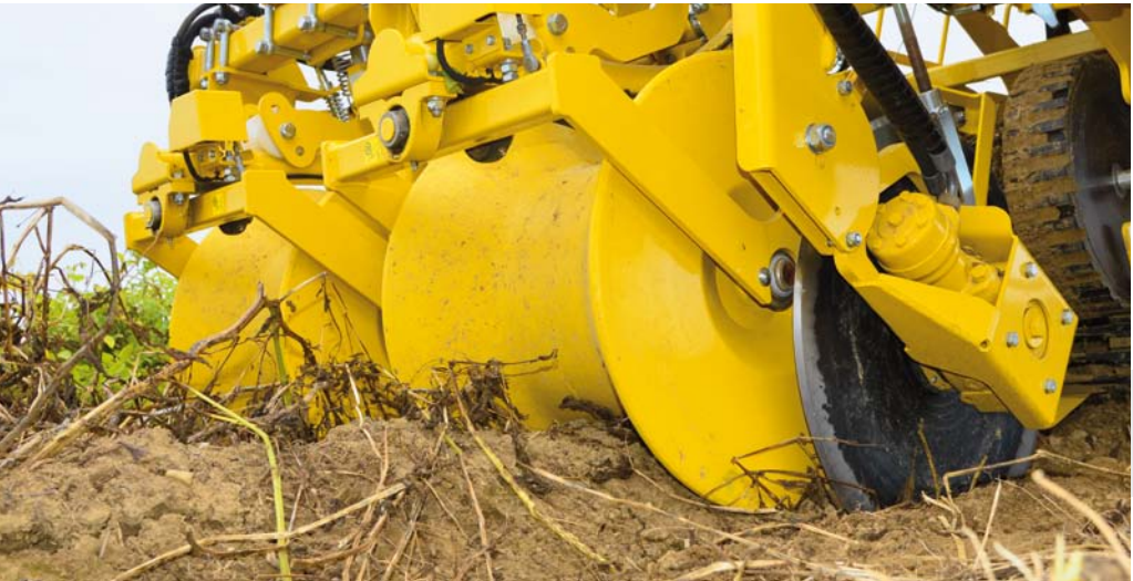
Bis zu 4 hydraulisch angetriebene Scheibenseche (2x innen, aussen links und rechts)
