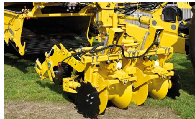
Dammaufnahme mit beidseitig gezackten Hohlscheiben
