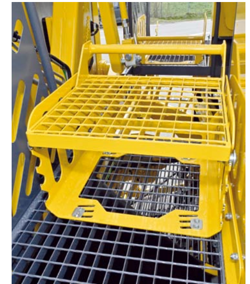
Höhenverstellbare Podeste, frei positionierbar
