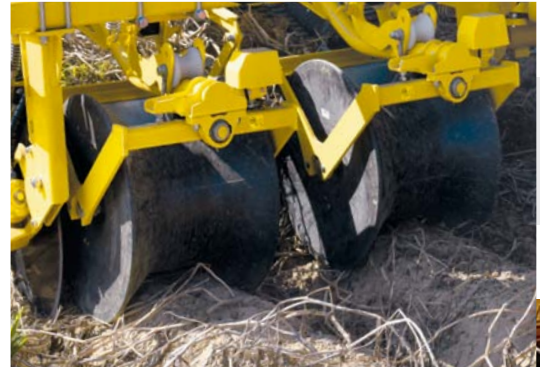
Dammtrommeln aus Kunststoff, hydraulisch angetriebenes Scheibensech aussen
