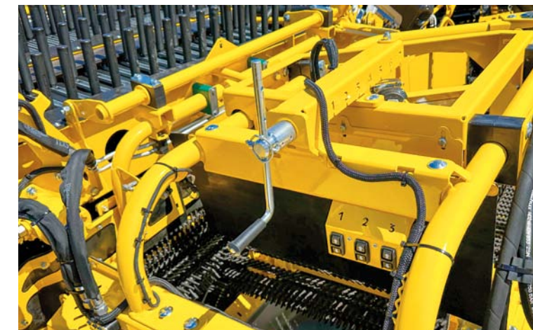
Horizontale Verschiebung der Ableitwalzen am Igel 3
