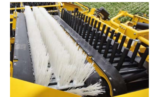
Gemischter Fingerkamm und Bürstenkamm
